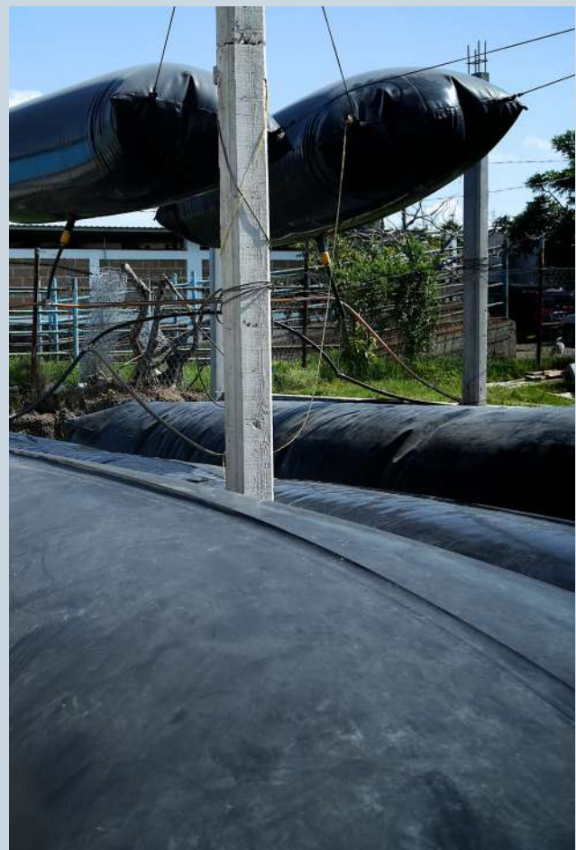
Imagen 2: Biodigestores tubulares de plástico (Ecuador) (arriba izquierda), de geomembrana de polietileno (México) (derecha), de geomembrana de PVC (Costa Rica) (abajo izquierda)
