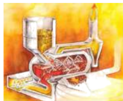
Figura 26. Tostador de tambor rotatorio (tomado de Schwartzberg, 2002)
