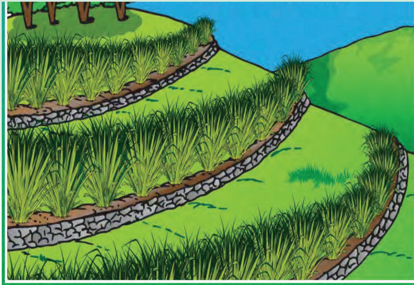
Figura: Curva a nivel, diseñada con el aparato “A”, combinación de barreras vivas con barreras muertas.
